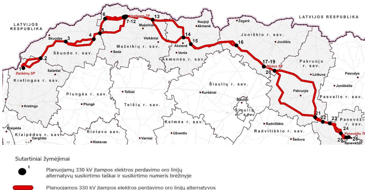
2 pav. Preliminarios 330 kV elektros perdavimo oro linijos trastos alternatyvos (A), (B) ir (C)
