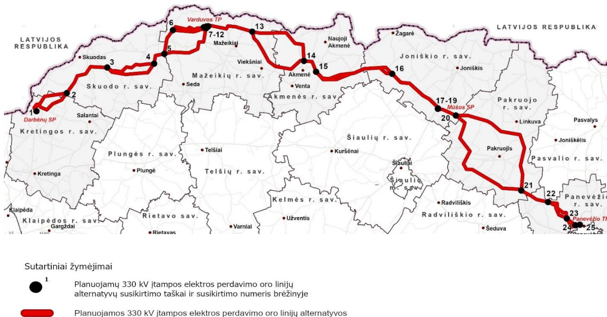
3 pav. Preliminarios 330 kV elektros perdavimo oro linijos trasos alternatyvos (A), (B) ir (C)
